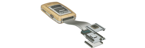
图2 TKScope K系列仿真器
