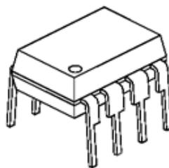
图 1 PIC12C508 单片机外型
